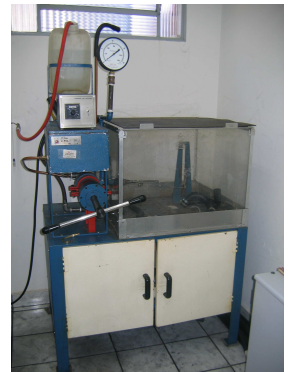
Teste Cíclico - Tração e Compressão
